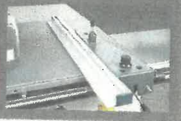
Elfordítható párhuzamvonalzó mikro beállítással a keskeny munkadarabokhoz
