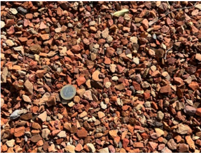
48. kép Zöldtető keverékhez előkészített vörös salak kétszeri rostálás után. A fagyálló, tört szemcsék jó szerkezetet biztosítanak. A víz- és tápanyagmegtartó képessége miatt kiváló alapanyag extenzív és intenzív ültetőközegbe egyaránt. Fotó: Székely Gábor
