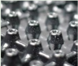
33. kép Kétoldalán dombornyomott preforált drénlemez. Fotó: Csabina Péter
