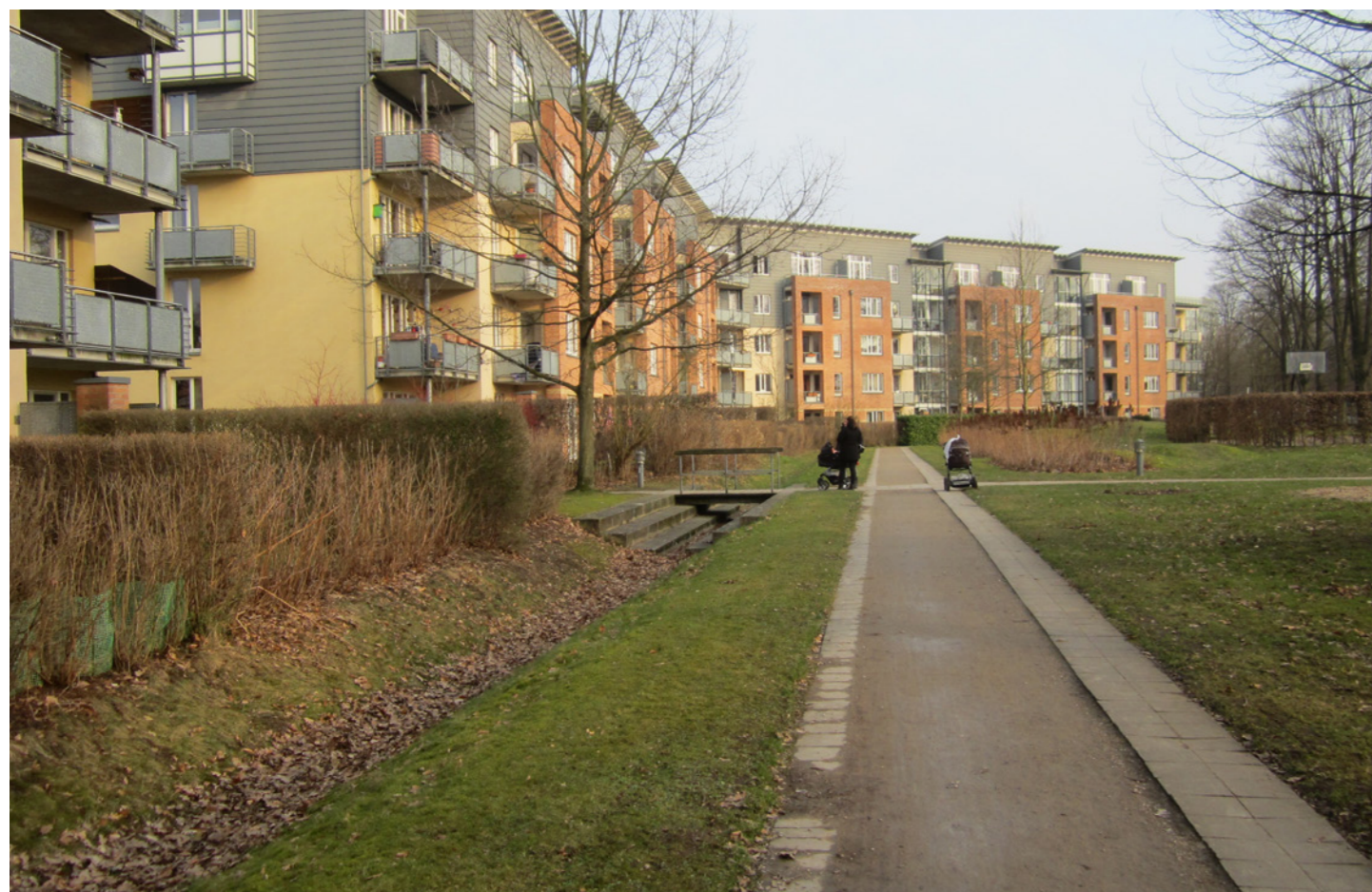
63. fotó A lakónegyed külső karéjának csapadékvizét nyílt gyepes árok gyűjti és köti be a központi vízfolyásba
