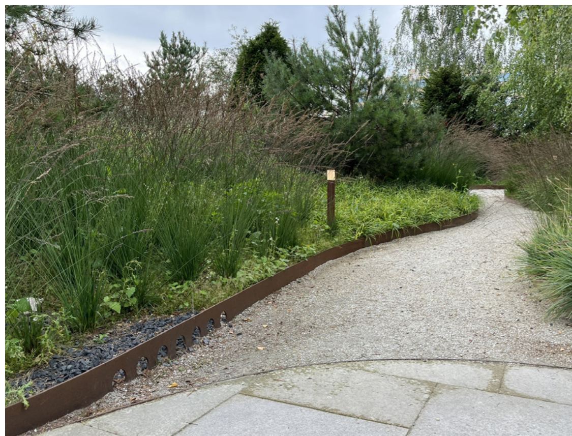
9. fotó Áttört szegély, vízáteresztő burkolat és esőkert a koppenhágai Opera parkban
