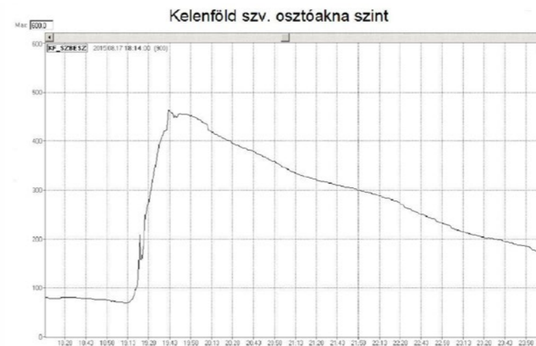
22. ábra: A Kelenföldi Szivattyútelep osztóaknájának vízszint görbéje az egyesített hálózaton beérkező csapadékvizek hatására 2015.08.17-én (forrás: FCSM Zrt. adatszolgáltatása)
