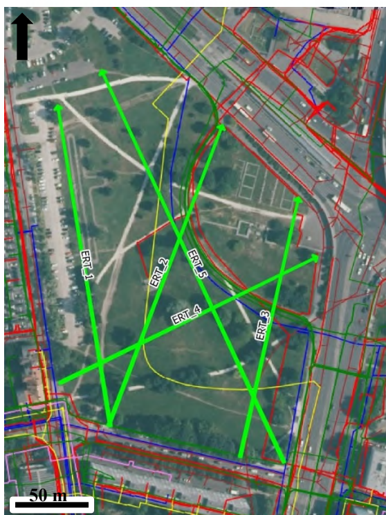
4. ábra: A mérési területen található közműhálózat (balra) és a Flórián tér egykori beépítettsége (jobbra) a geofizikai szelvényekkel (világoszöld) feltüntetve. A közműtérkép színekulcsa: zöld – hírközlési vezeték, sárga – gázvezeték, rózsaszín – távhővezeték, piros – villamosvezeték, kék – vízellátó vezeték, barna – vízvezeték.
