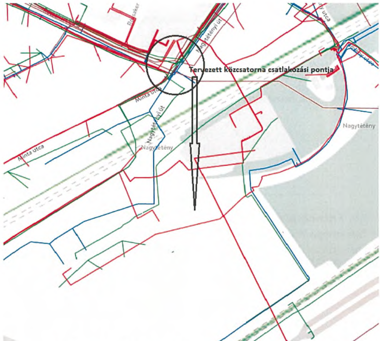
Tervezett közcsatorna csatlakozási pontja a FCSM Zrt. tájékoztatása alapján
