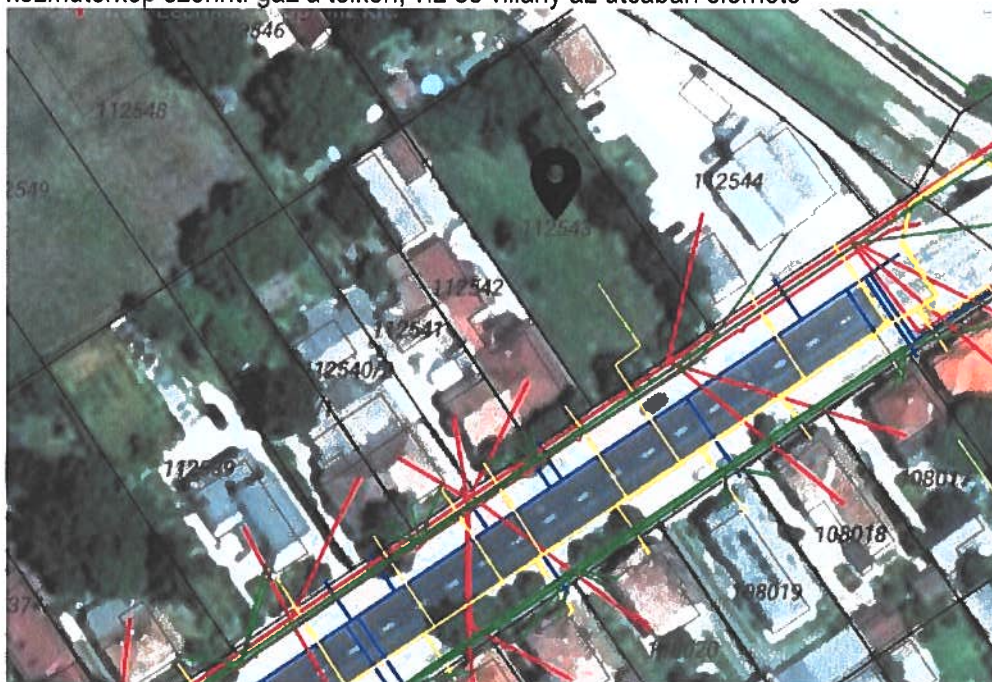
Jelmagyarázat: sárga vonal – gáz, piros vonal – villany, kék vonal – víz (a közműtérképen a csatorna vezeték nincs feltüntetve)
