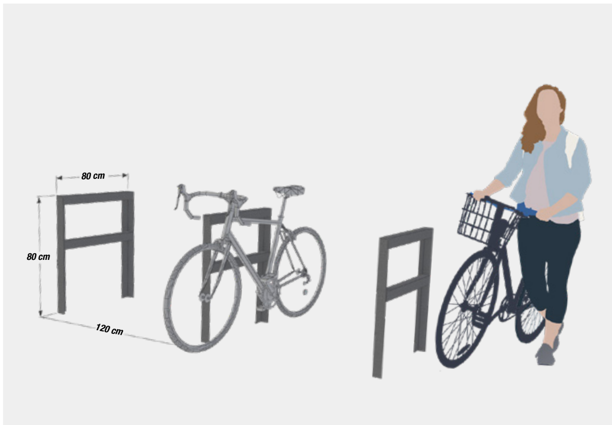
12. ábra: Kerékpártámasz méretei és elrendezése
